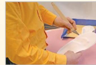
**3.** Orthopädie-Schuh-Techniker bearbeiten und prüfen den Einlagen-Rohling.
